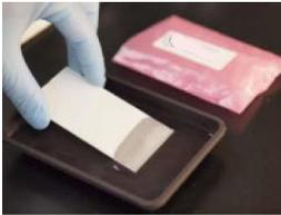
■ Leeren Sie den Inhalt eines Farbstoff-Mikroröhrchens vorsichtig in die Tauchschale und spülen Sie sie mit Wasser aus, damit das Pulver an dem Mikroröhrchen haften bleibt. Fügen Sie Wasser hinzu, indem Sie den 25-ml-Becher voll machen.
